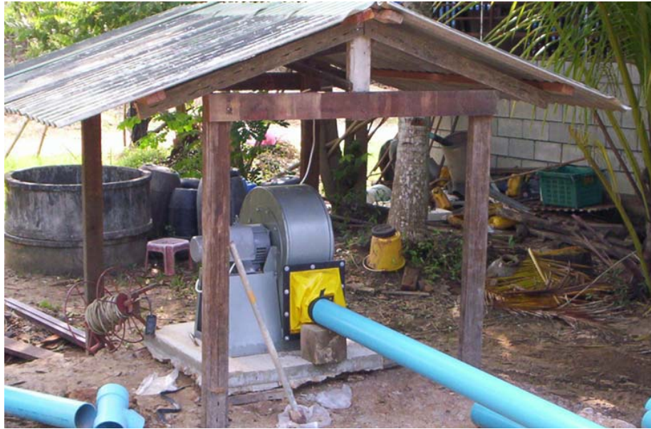
ภาพที่ 9.5 ภาพแสดงพัดลมโบลเวอร์แบบกรงกระรอก 15 นิ้ว มอเตอร์ 3 แรงม้า ไฟ 220 V
