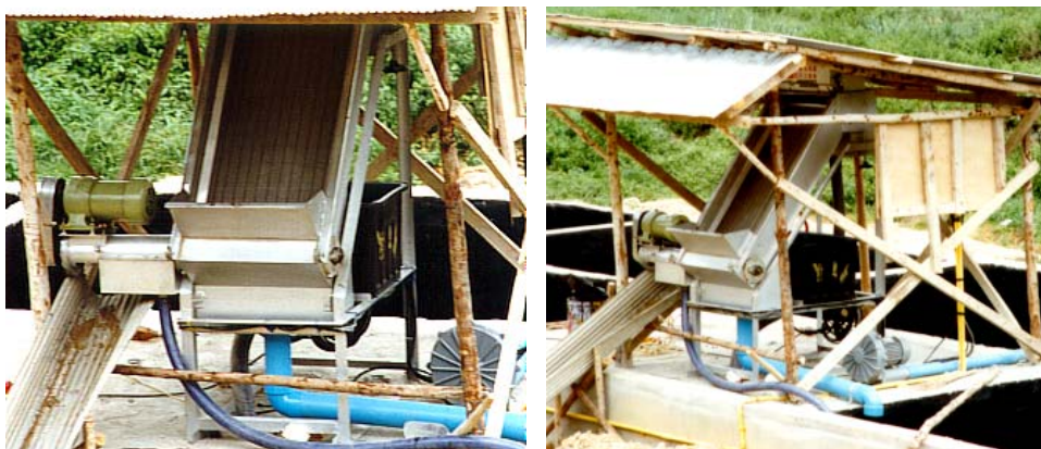
ภาพที่ 10.3 เครื่องแยกมูลสุกรและตมออก ส่วนที่เป็นน้ำถูกส่งไปยังบ่อตกตะกอน
