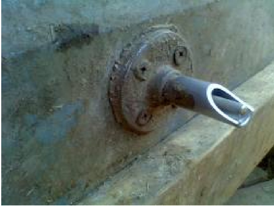
ภาพที่ 4.54 ชุดให้น้ำสุกรแบบจุ่ม
