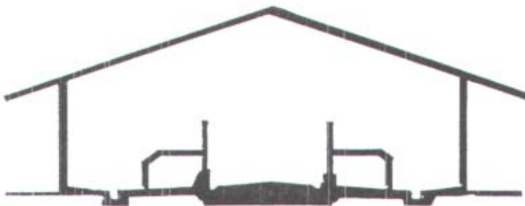
ภาพที่ 4.69 แผนผังโรงเรือนเลี้ยงโคนมแบบยืนโรงแบบ 2 แถว หันหน้าเข้าหากัน
