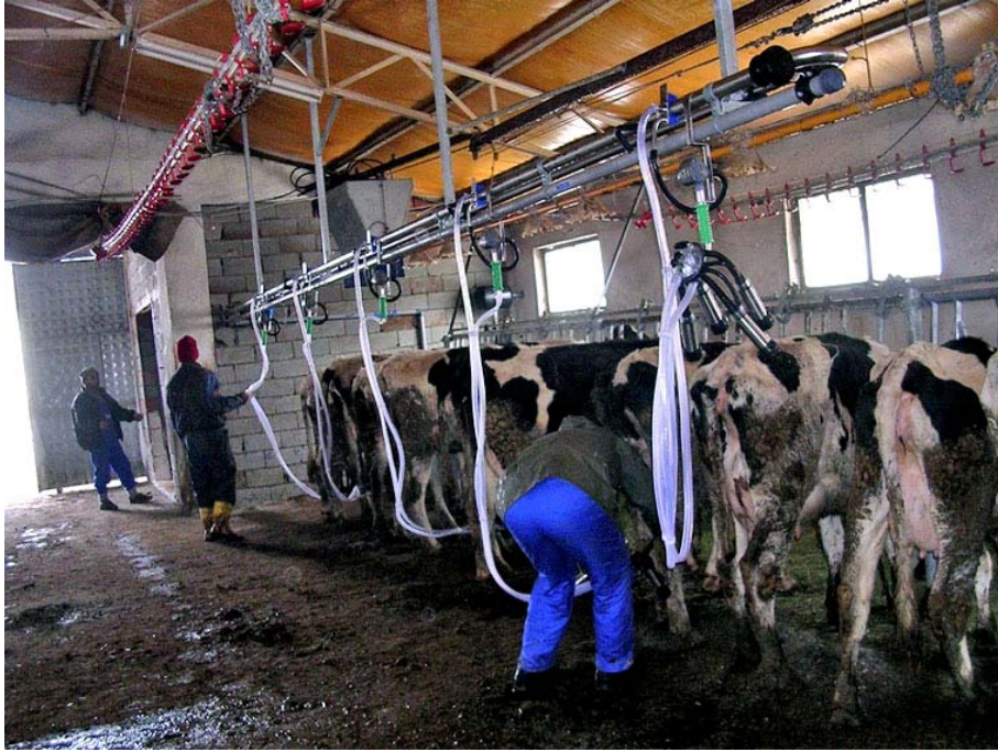
ภาพที่ 4.85 เครื่องรีดแบบรีดนมแล้วน้ำนมจะถูกส่งไปตามท่อเพื่อเก็บไว้ในถังพักนม
