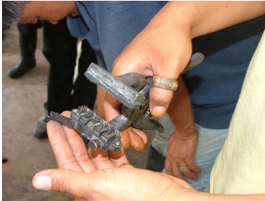
ภาพที่ 6.111 แสดงคีมสักเบอร์หู พร้อมเข็มสักที่เป็นหมายเลข จัดเรียงตามต้องการ
