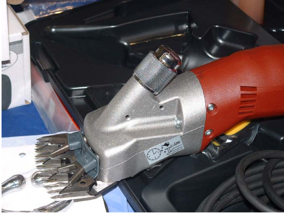
ภาพที่ 6.71 แสดงปัตตาเลี่ยนไฟฟ้าสำหรับตัดขนแกะ
