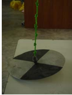
ภาพที่ 2.3 ลักษณะของเซกซีดิสก์ (secchi disc)
