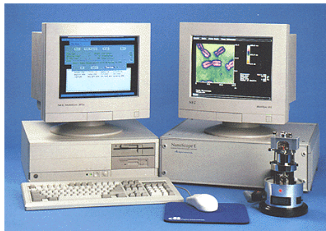
ภาพแสดงระบบกล้องจุลทรรศน์ แบบสแกนนิ่ง ประกอบด้วย คอมพิวเตอร์ (ซ้าย) เครื่องควบคุมและจอแสดงภาพ (ขวา) และตัวกล้อง (ล่างขวา)
